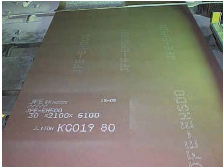
采用底漆处理的标准EVERHARD厚钢板(EVERHARD-500(JFE-EH500))的典型外观示例
